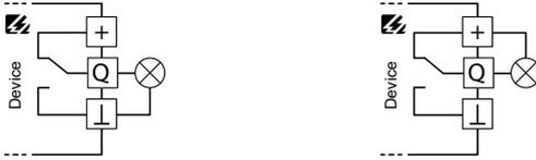
Im **passiven Modus** kann eine externe Spannung angeschlossen werden (siehe Technische Daten). Der Ausgang schaltet das angelegte Potential auf GND.
